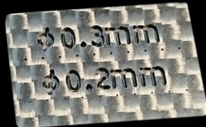
微細穴加工 (φ0.3mm) (φ0.2mm)
